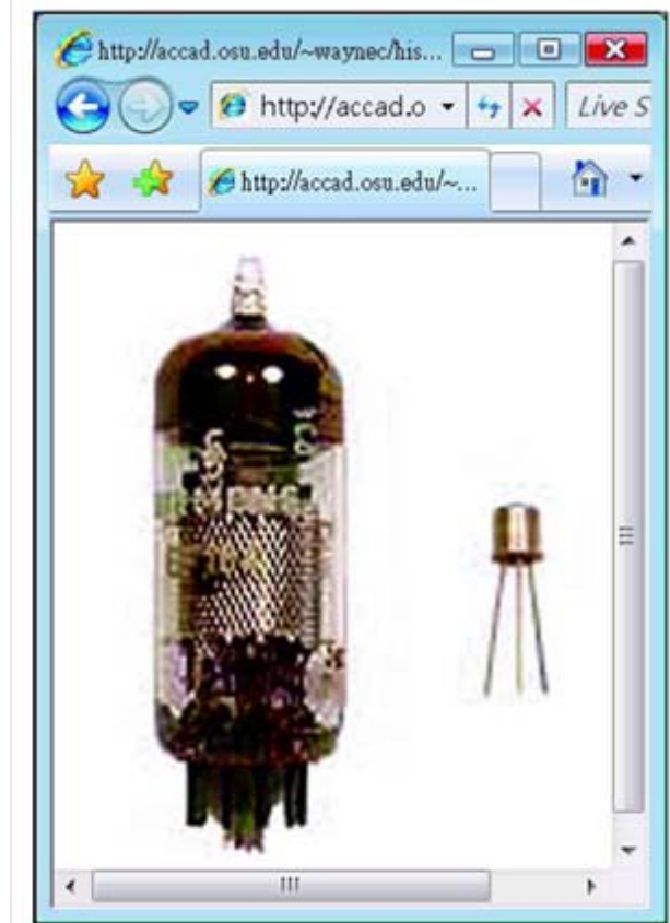
圖 1-7 真空管 (左) 與電晶體
